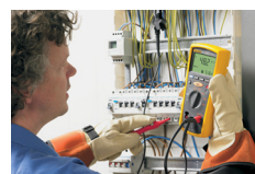
Isolatietest aan een verdeelpaneel
